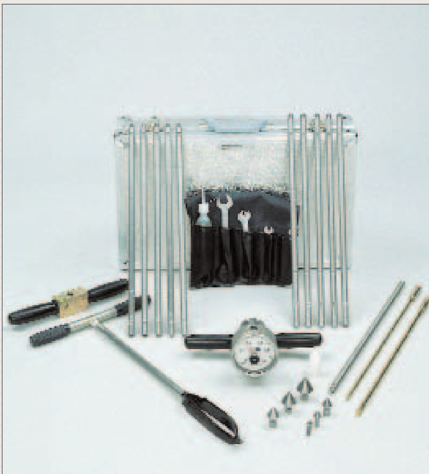
Pénétromètre manuel EIJKELKAMP (SB)
