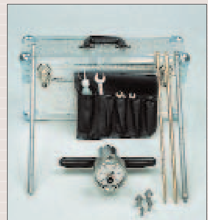
Pénétromètre manuel "EIJKELKAMP" (SA)
