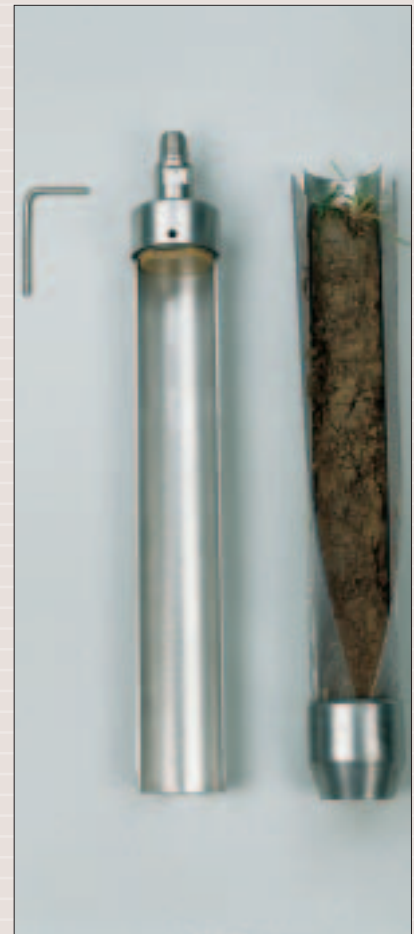
Carottier avec échantillon (dans sa gaine)
