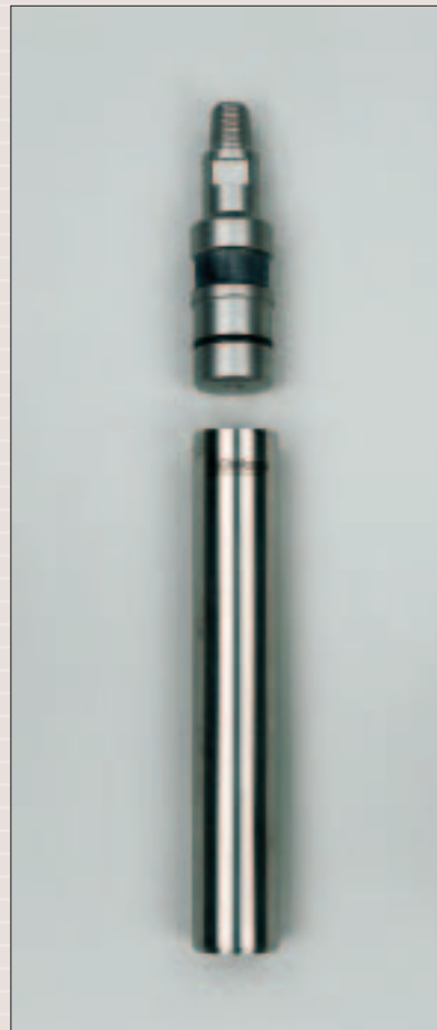
Tête et tube du carottier
