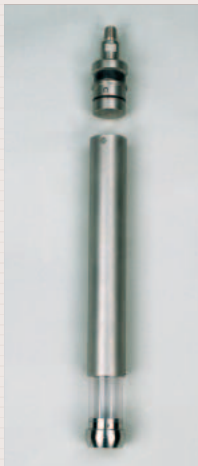
Carottier, tube et trousse coupante
