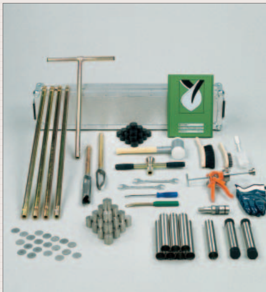
Ensemble d'échantillonnage de sol (pour analyses chimiques)
