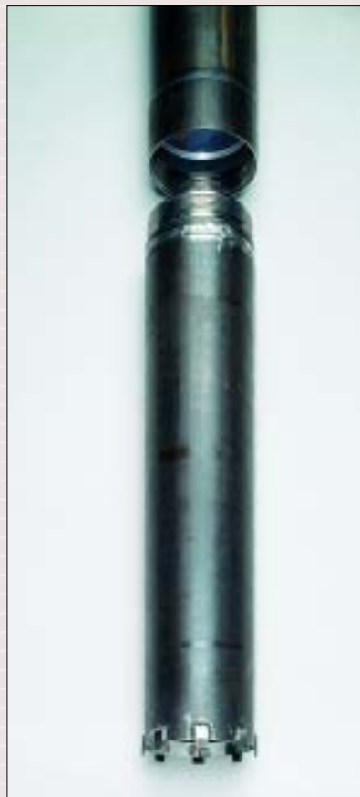
Tube de soutènement avec couronne d'attaque 220 mm
